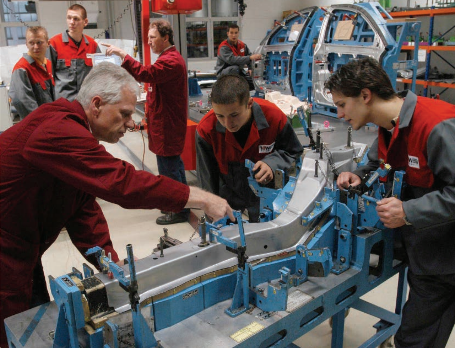
▲ Know-how von Beginn an: Auszubildende prüfen im Messraum einen Längsträger für den BMW X1
