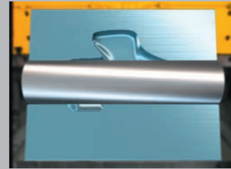
1. Rohr wird in das Werkzeug eingelegt
