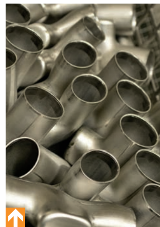
Großserie bei Salzgitter Hydroforming: auch bei Fittings und T-Stücken ist ein Teil wie das andere
