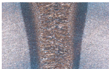
Oben: Gefüge der Lasernaht: vollständig durchgeschweißt
